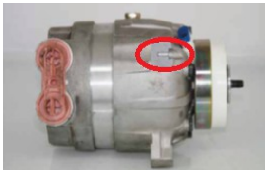
Suport si corp deteriorat.
